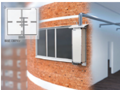
Монтаж на вертикальной раме на улице. Способ 4.
